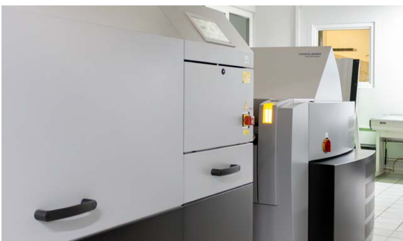
Druckplattenbelichter Heidelberg SupraSetter 106 Vollautomat mit Auto Pallet Loader (APL)
