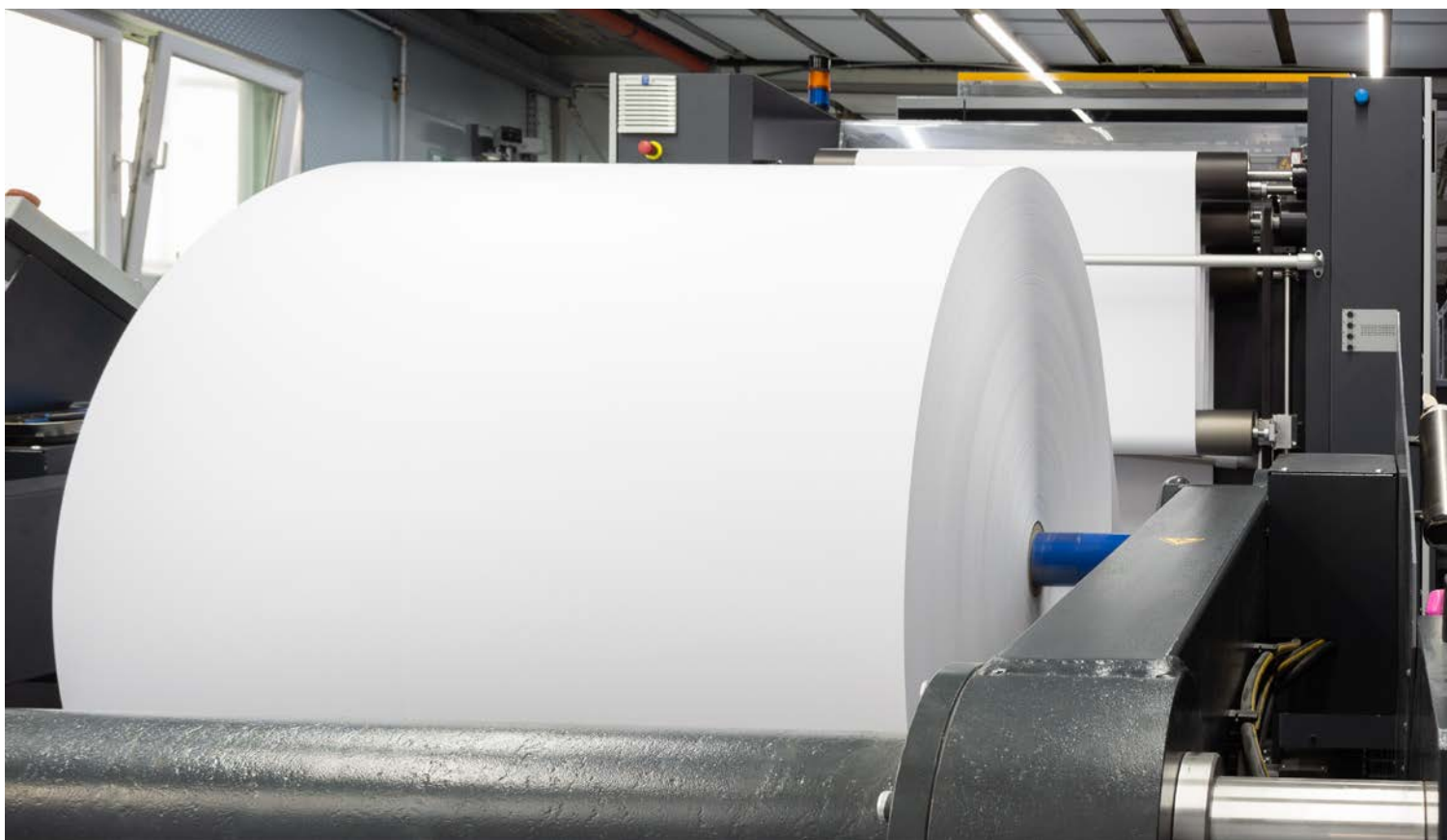
Mabeg Rollenschneider RS 106 an der Heidelberg Speedmaster XL 106 8C 4/4
