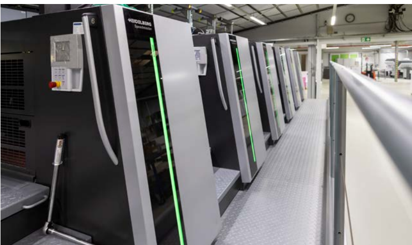
neu installierte Offsetdruckmaschine Heidelberg Speedmaster XL 106 5C + Lack (UV) mit Prinect Inpress Control, inkl. Cito Inline-Stanzen und Perforieren
