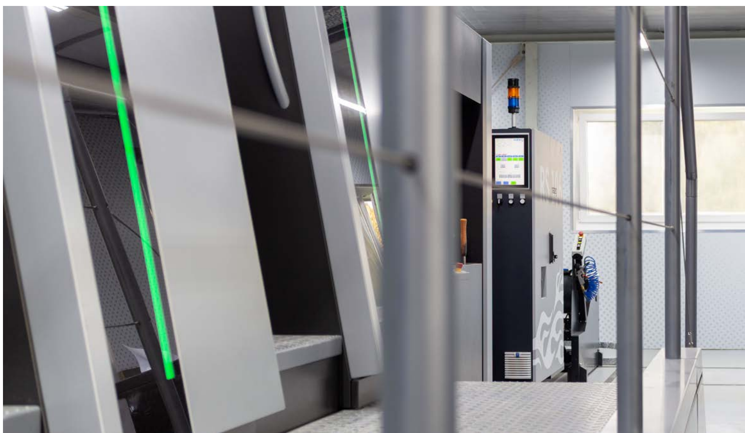
Mabeg Rollenschneider RS 106 an der neu installierten Offsetdruckmaschine Heidelberg Speedmaster XL 106 8C 4/4
